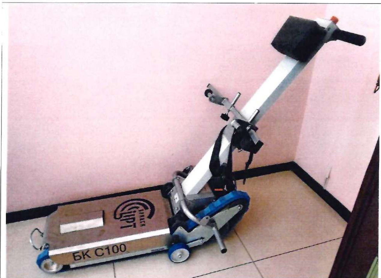
Фото № 13. Гусеничное подъемное устройство БК С100 (Подъемник для инвалидной коляски по лестнице)
